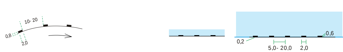
7.2.20. Okomita obaloutvrda od kamena ili betona - pristanište
